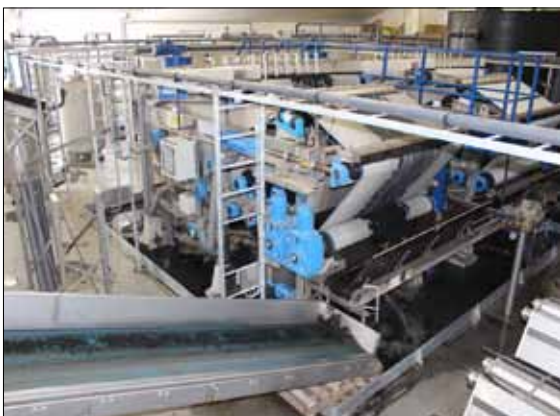
Aus dem Ausgangsstoff wird in einem vierstufigen Verfahren klares Wasser, flüssiges Düngerkonzentrat sowie ein wertvoller Feststoff gewonnen.
