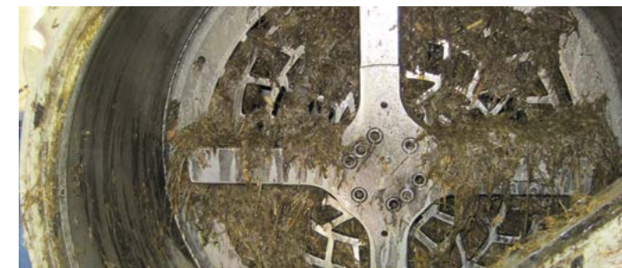
Der Mazerator sorgt für eine zuverlässige Substratzerkleinerung und scheidet nach der Anmischung Fremdkörper ab
