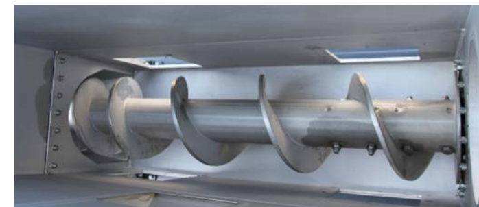
Die Anmischung der festen Substrate erfolgt bereits im ersten Schritt
