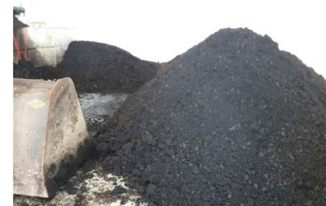
Der entwässerte Feststoff hat einen TS-Gehalt von rund 30 Prozent und ist ein transportfähiger und nährstoffreicher Dünger.
