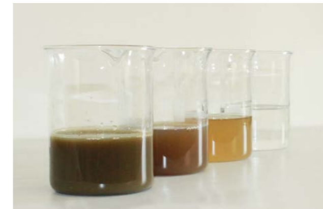
In vier Verfahrensschritten werden die Feststoffe der Gülle vom Wasser getrennt. Übrig bleiben Wasser, ein Nährstoffkonzentrat und fester Dünger.
