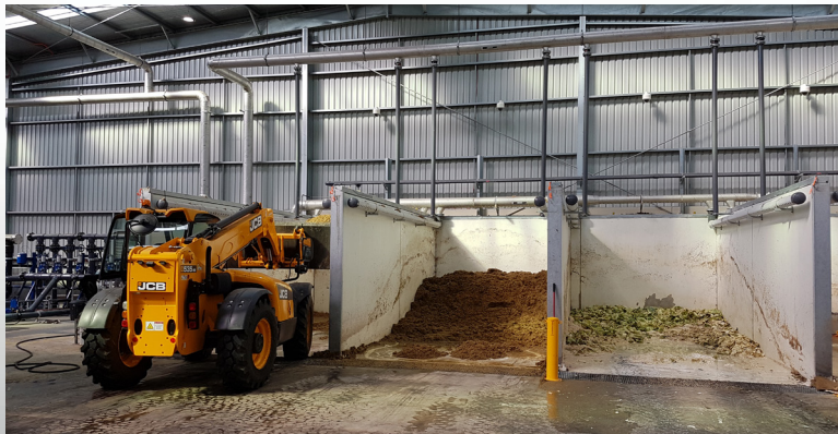
Die festen Substrate werden in Bunkern direkt neben dem Dosierer gelagert.
